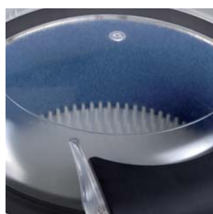
DETALLE INTERIOR PELAMEJILLONES.
